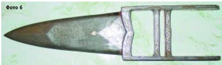
рических зерен карбида железа (цементита). Благодаря своей уникальной структуре, вутц сочетает два свойства, считающиеся в металлургии противоположными, – твердость и вязкость. Зерна цементита, выходящие на поверхность режущей кромки, образуют на микроуровне пилу или, иными словами, своеобразный микросеррейтор. За счет этого обеспечиваются выдающиеся режущие свойства клинков из вутца.
